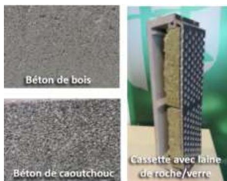
Exemple de dispositif insonorisant et invisible
