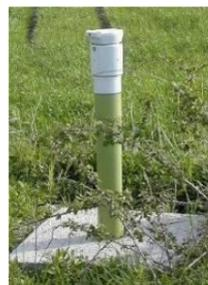
Piezomètre mis en place
