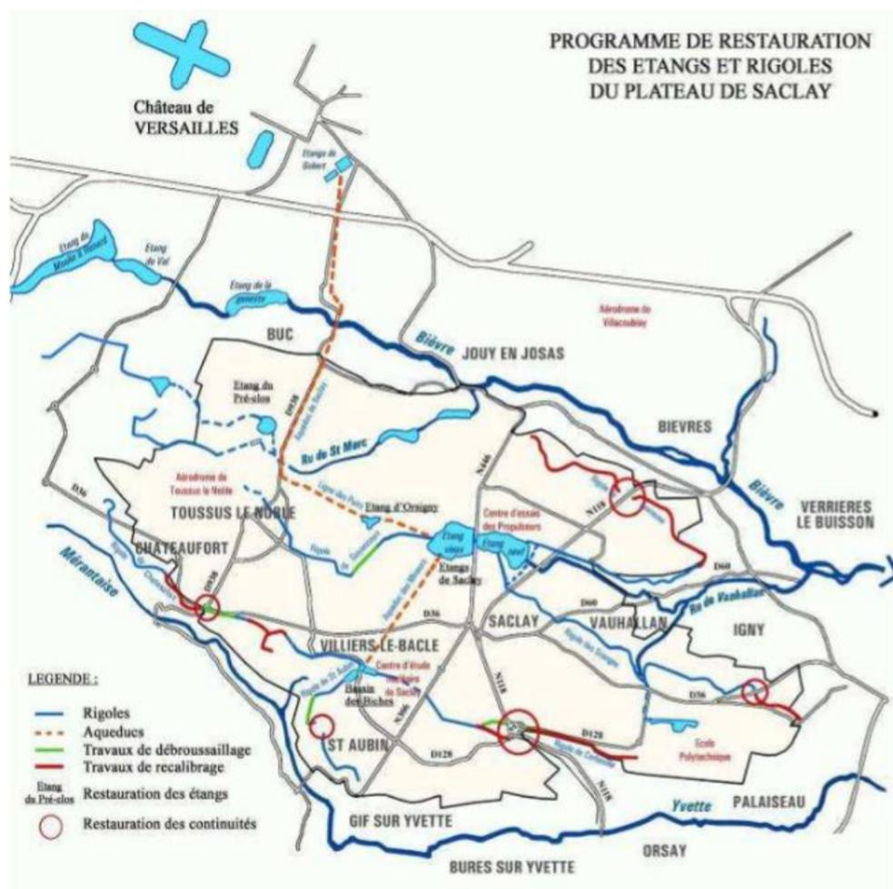
Réseau de rigoles et d'étangs du plateau de Saclay issu du plan de restauration
