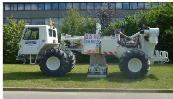
Exemple de camion sismique
